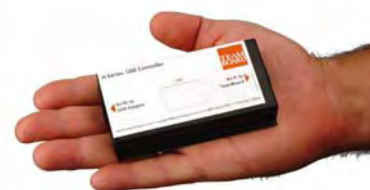
TeamBoard egyedi vezérlő. A TeamBoard egyedi vezérlőt olyanra tervezték, hogy a helyszínen könnyen kicserélhető legyen, mialatt a tábla a falon lóg.
